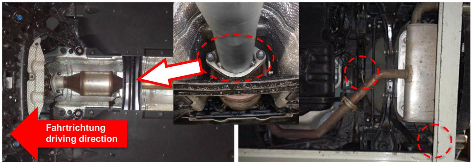
Die REMUS Verbindungsrohre am Serienflansch montieren und die Gummiaufhängung am Befestigungspunkt der Karosserie einhängen.
